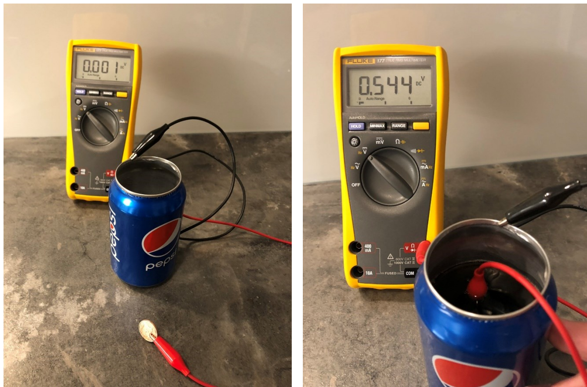
Slika 3: Priklop žic, vezava na voltmeter in namestitev kovanca v tekočini.
