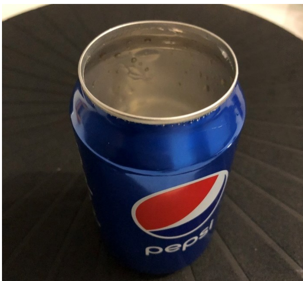
Slika 1: Odstranjevanje zgornjega dela pločevinke in brušenje ostrega robu.
