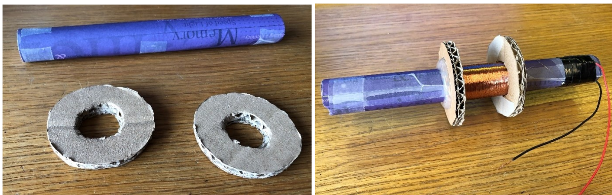
Slika 3: Primer navitja tuljavnika s 1000 ovoji lakirane bakrene žice na kartonasto votlo cev in robnimi vodili za žico. Debelina žice je zgolj 0.1 mm!
