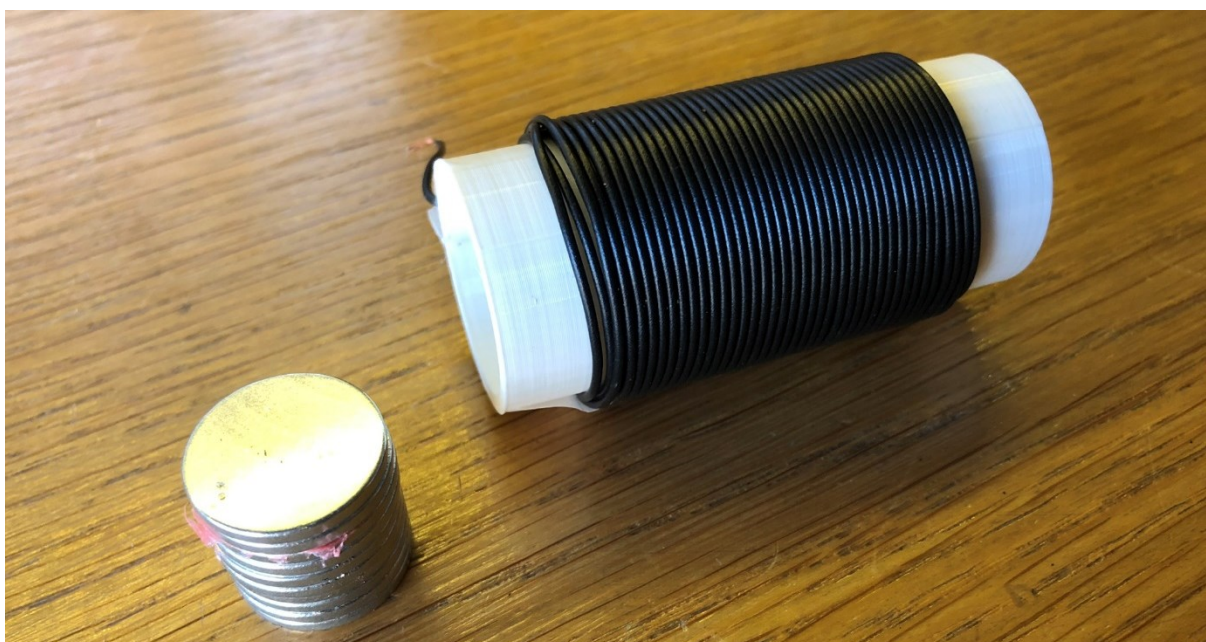
Slika 2: Primer navitja tuljave na votlem plastičnem tulcu. Žica je precej debela, zato je število ovojev majhno. Magneti še niso ustrezno zaščiteni.
