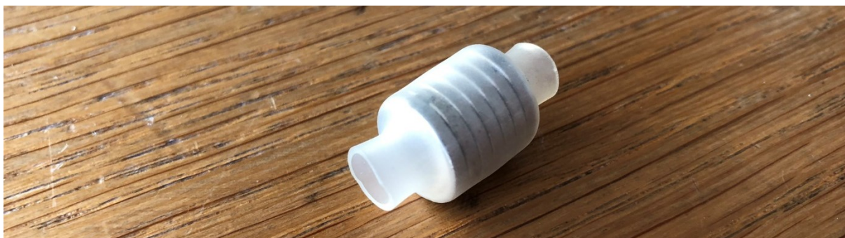
Slika 1: Magnetni zavarovani s termo-krčljivo cevko.
