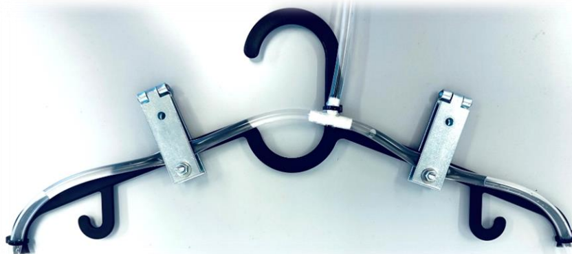
Slika 3: Razdelitev cevi s pomočjo obešalnika in neodvisno nastavljanje pretoka s sklepno spono.
