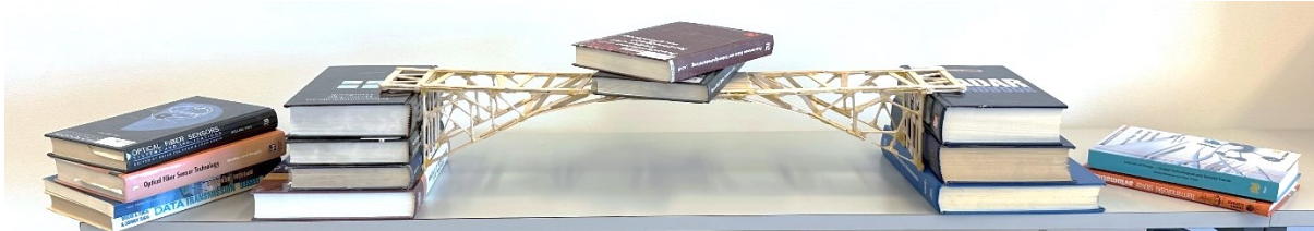
Slika 9: Primer izdelanega mostu, obteženega in podprtega s knjigami
