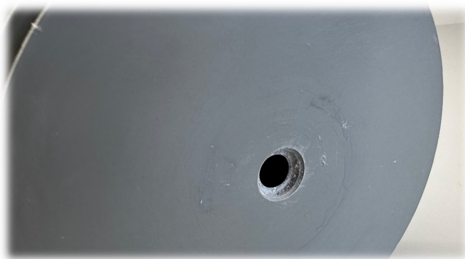
Slika 5: Šoba izstopnega dela (iz notranjosti je nalepljena aluminijasta ploščica).
