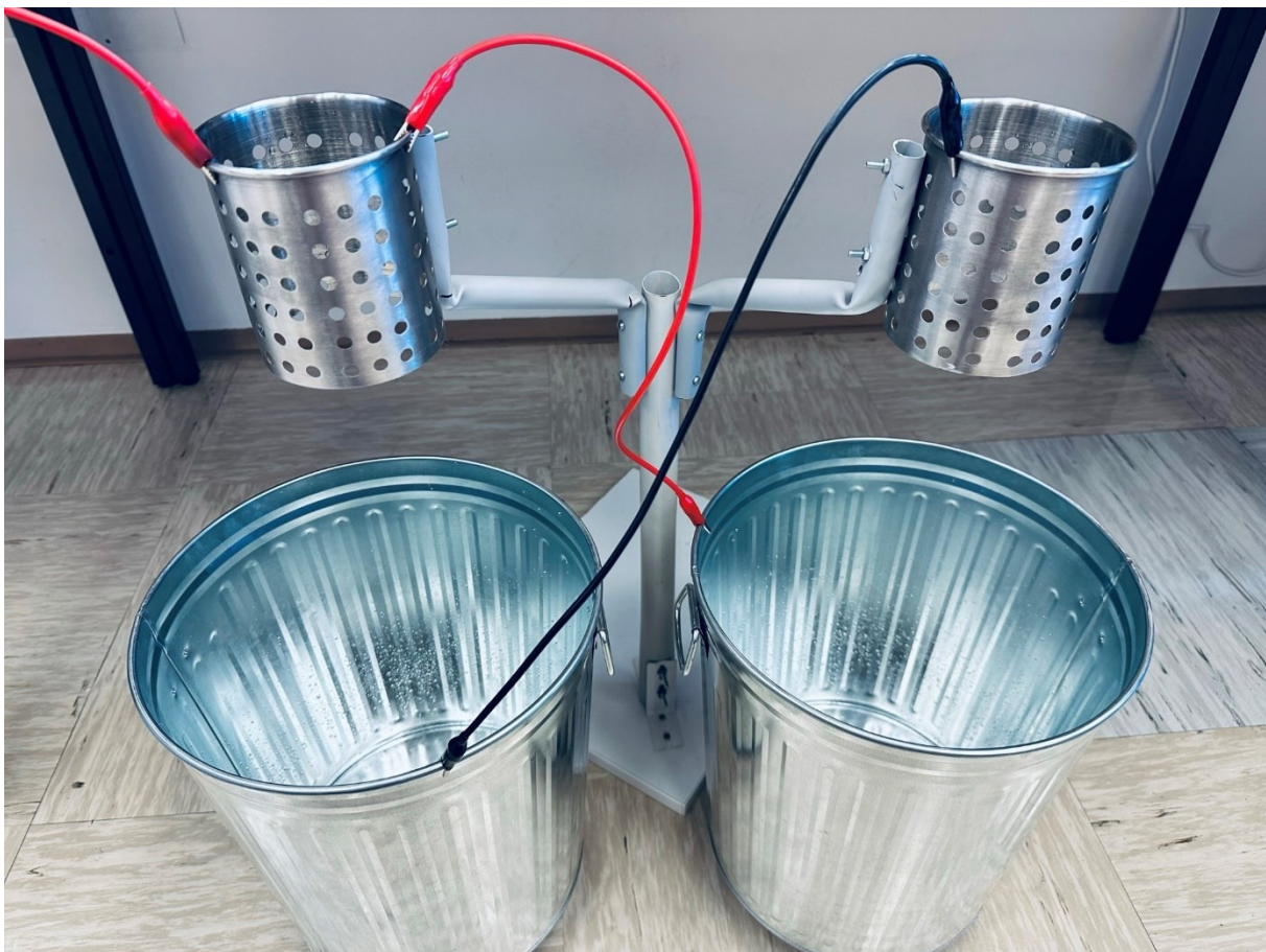
Slika 4: Zbirni posodi in kovinska obroča, povezani z laboratorijsko žico na krokodilčke.
