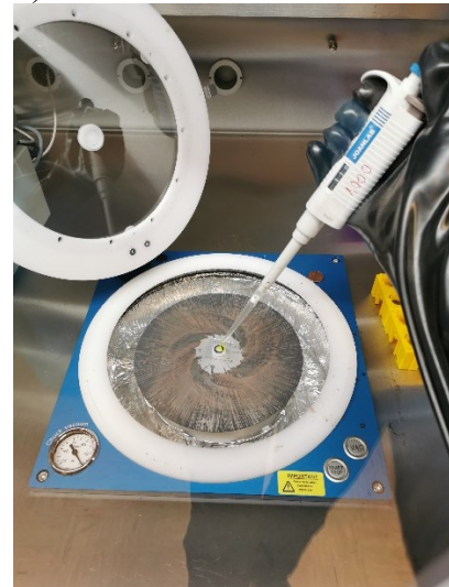
Slika 3: a) Dušikove komore z rokavicami, kjer poteka izdelava perovskitnih sončnih celic v laboratoriju LPVO na Fakulteti za elektrotehniko v Ljubljani. b) Spinski nanašalec.
