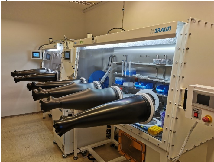
Slika 3: a) Dušikove komore z rokavicami, kjer poteka izdelava perovskitnih sončnih celic v laboratoriju LPVO na Fakulteti za elektrotehniko v Ljubljani. b) Spinski nanašalec.
