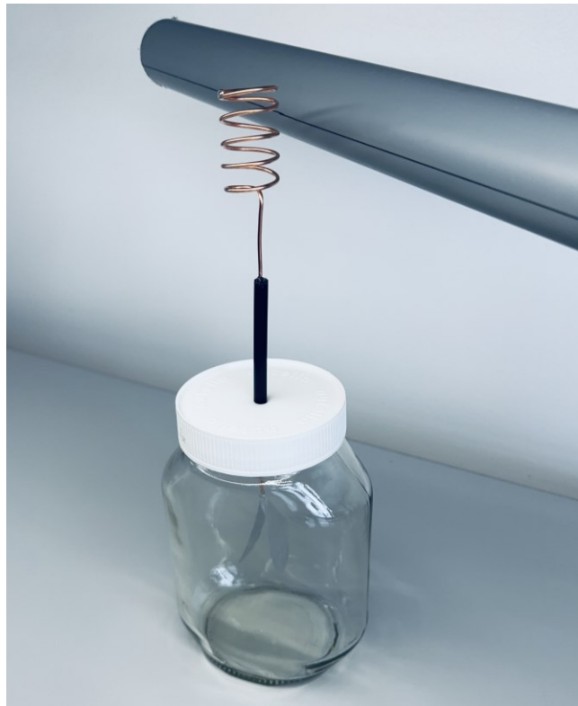
Slika 5: Delovanje elektroskopa z uporabo naelektrene PVC cevi. Lističa sta med seboj razmaknjena.
