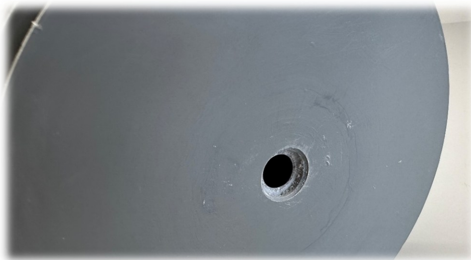
Slika 14: Šoba izstopnega dela (iz notranjosti je nalepljena aluminijasta ploščica).
