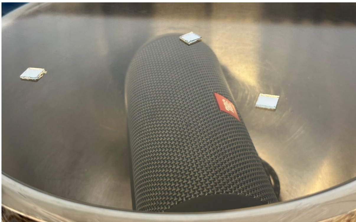
Slika 5: Primer namestitve treh zrcalc na membrano iz folije za živila
